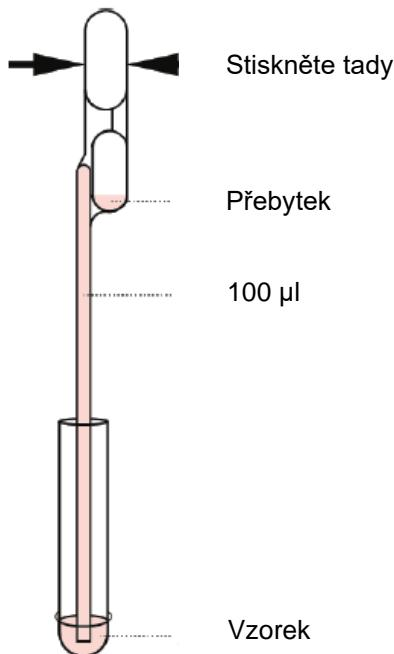
Chcete-li vzorek nasát do pipety, nejdříve pevně zmáčkněte horní balónek a vložte špičku pipety do vzorku. Balónek pomalu a plynule uvolněte tak, aby kapalina zaplnila celou špičku (válec) pipety. Ujistěte se, že jste zcela naplnili špičku (válec) pipety a v dolním balónku je jenom malý přebytek (málo vzorku, tzv. mrtvý objem) a že ve válci pipety **nejsou žádné bubliny**.
