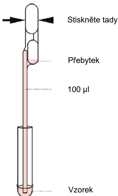
Vyjměte pipetu z kontrolního vzorku a pevným stlačením horního balónku vytlačte celý objem kapaliny z válce pipety do prázdné mikrozkumavky. Měl by se uvolnit celý objem kapaliny 100 ul. Pokud ve spodním balónku zůstane malé množství vzorku, je to v pořádku. **Spodní balónek nikdy nestlačujte.**
